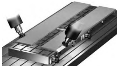
Resim 8.7G - Bıçaklara profil açılması ve sacların pahlanması
